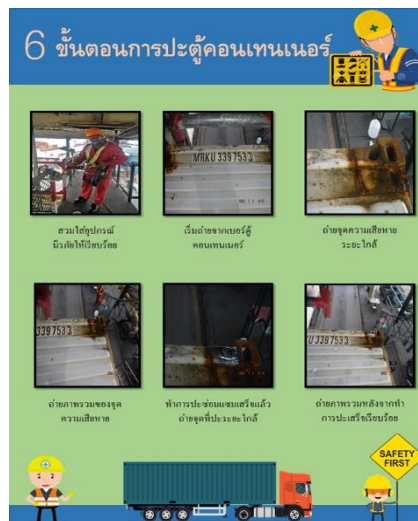
รูปที่ 3 การปรับปรุงขั้นตอนการปฏิบัติงานปะตู้คอนเทนเนอร์โดยปรับปรุงขั้นตอนให้ดีขึ้น
