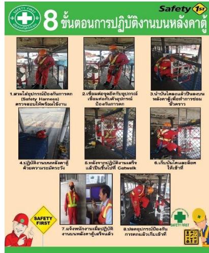
รูปที่ 2 จัดทำป้ายแสดงขั้นตอนการปฏิบัติงานบนหลังคาคอนเทนเนอร์
