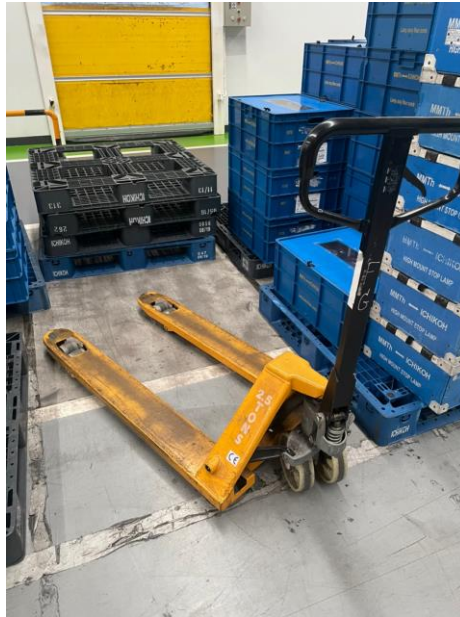
ภาพที่ 3 ภาพแสดงการเก็บ Handlift ที่ไม่เป็นระเบียบ มีการจอด Handlift ไว้ในที่วางสินค้า ทำให้พนักงานคนอื่นอาจจะหา Handlift ไม่เจอเมื่อ ต้องการใช้งาน
