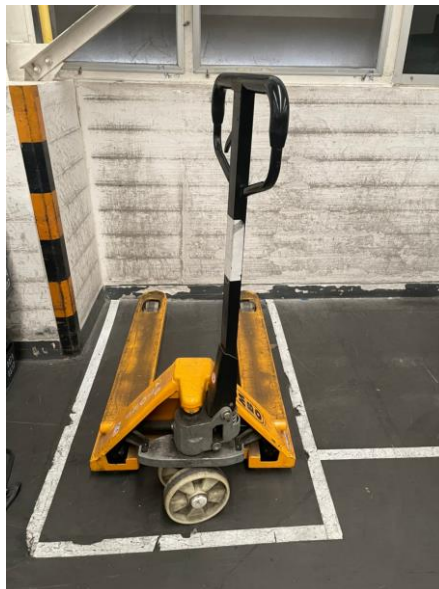
ภาพที่ 4 ภาพแสดงการจัดเก็บ Handlift ที่เป็นระเบียบ มีการจัดเก็บ Handlift ภายในพื้นที่ที่ถูกตีกรอบขึ้นใหม่ ทำให้เกิดความเป็นระเบียบ และยัง ง่ายต่อการหาอุปกรณ์
