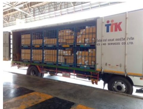
ภาพที่ 4 แสดงการวาง Side guard ภายในตู้ขนส่งสินค้า
